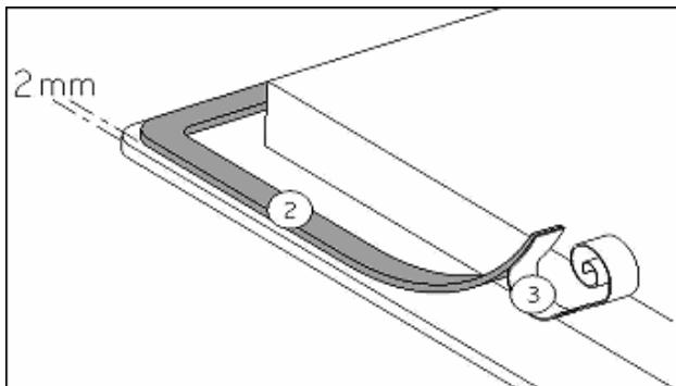
Die Dichtung (2) nach Abnehmen der Schutzfolie (3) mit 2 mm Abstand der Außenkannte des Glases aufkleben.
