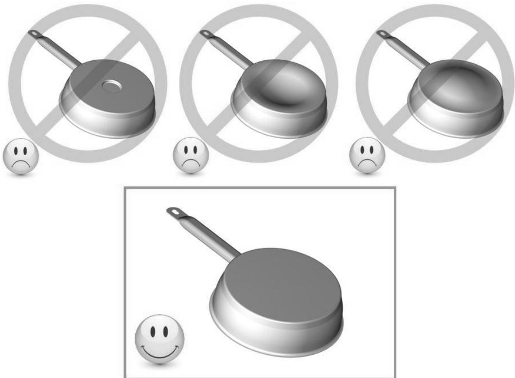
Se il fondo della pentola ( $\varnothing d$ ) è significativamente più piccolo del diametro del corpo ( $\varnothing D$ ) **il rendimento ne è penalizzato e la pentola rischia di non essere identificata dalla piastra**
