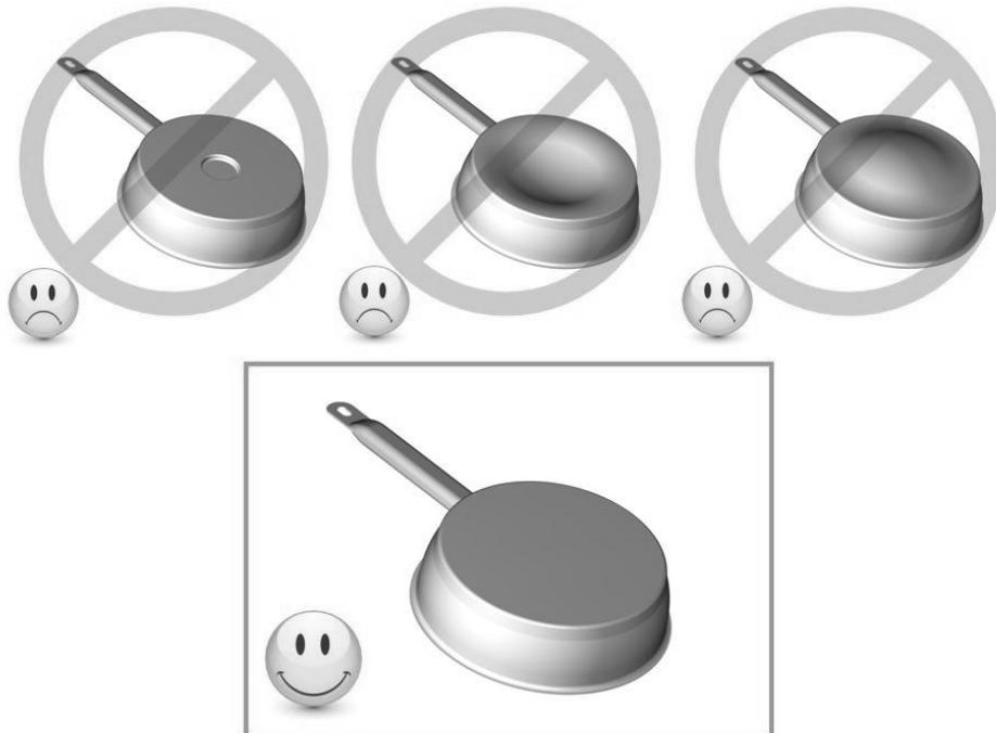
Sollte der Boden des Topfes ( $\varnothing d$ ) bedeutend kleiner als der Durchmesser des Körpers ( $\varnothing D$ ) sein, führt dies zu einer Leistungsminderung, und der Topf könnte möglicherweise nicht vom Kochfeld erkannt werden
